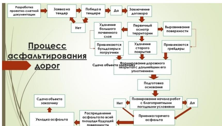
Рис. 1. Схема бизнес-процесса асфальтирования дорог
