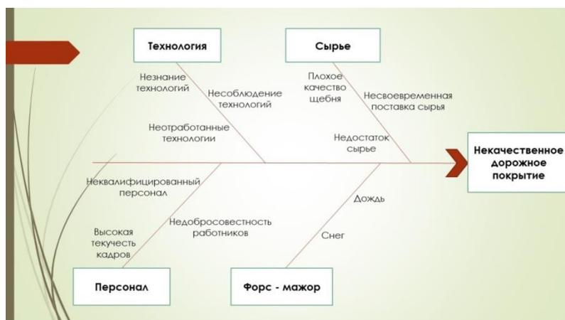
Рис. 4. Диаграмма причин и результатов (схема Исикавы) при асфальтировании дорог
